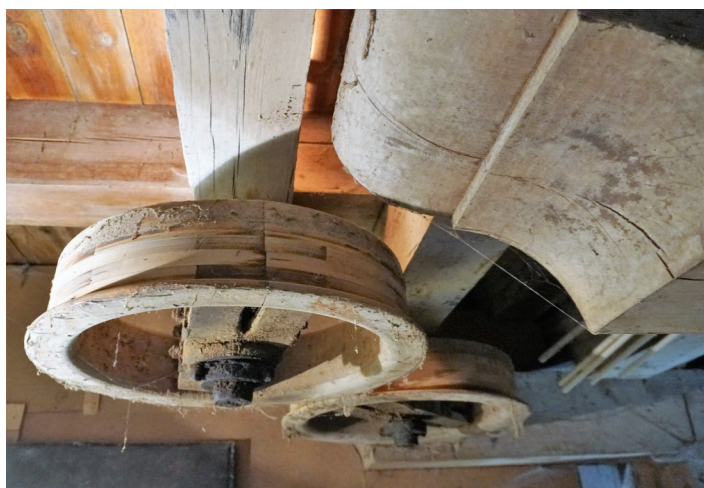
Remskivor för remmarna till driften av kvarnstenarna.
